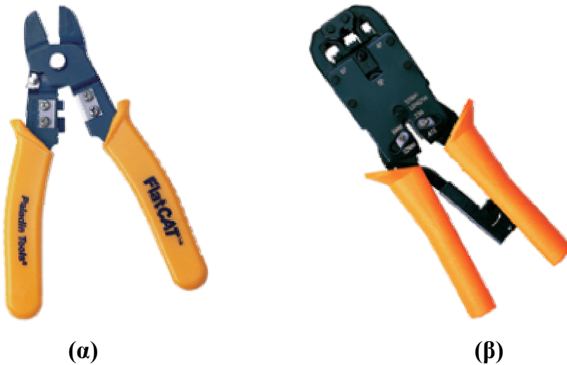
Σχήμα 6-2 (α)Εργαλείο απογύμνωσης καλωδίου, (β)Εργαλείο τοποθέτησης κλιπ
