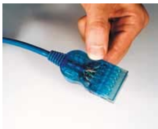
Σχήμα 8-5 Συνδετήρας τύπου 110 για άμεση σύνδεση με ρεγκλέτα.
