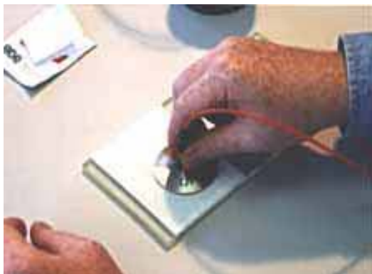
Σχήμα 3-17 Μετά την τοποθέτηση του συνδετήρα απαιτείται λείανση του ινιδίου. Μια διαδικασία χρονοβόρα και απαιτητική σε προσοχή.
