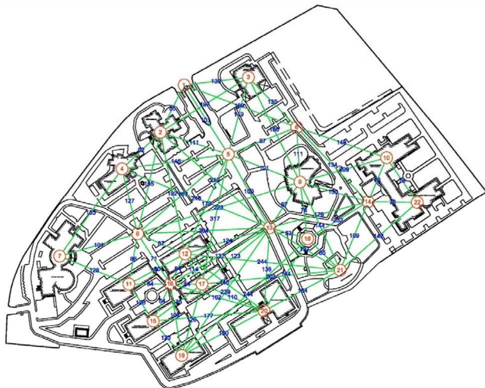
**Σχήμα 2.2: Γράφος στο υπόβαθρο του τοπογραφικού διαγράμματος των εγκαταστάσεων του Τ.Ε.Ι. Κεντρικής Μακεδονίας**
