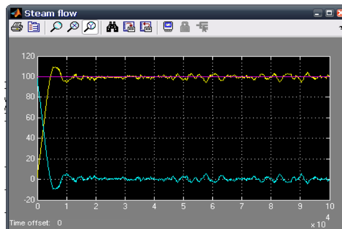
Σχήμα 5.3 Απεικόνιση της ροής ατμού για εισαγωγή θορύβου 1600 στην θερμοκρασία του boiler
