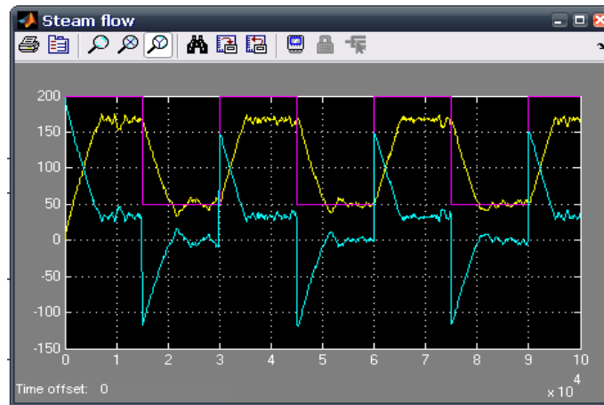
Σχήμα 5.15 Απεικόνιση της ροής ατμού για εισαγωγή θορύβου 4800 στην θερμοκρασία του boiler
