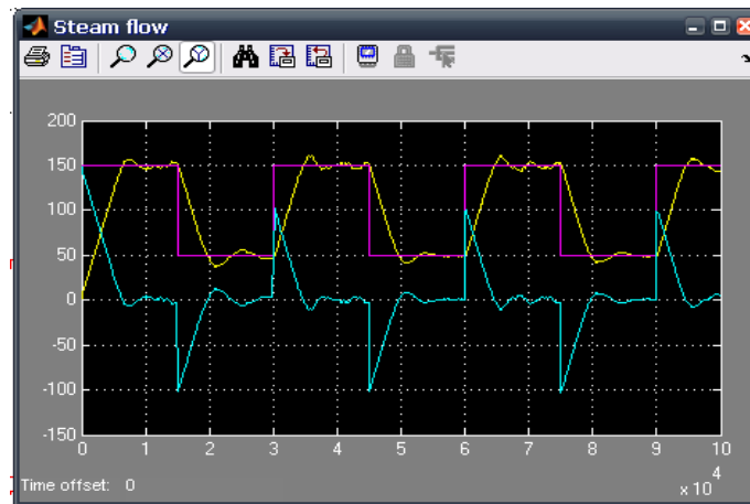
Σχήμα 5.5 Απεικόνιση της ροής ατμού για εισαγωγή θορύβου 1600 στην θερμοκρασία του boiler
