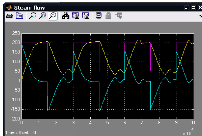
Σχήμα 4.30 Απεικόνιση επιθυμητής και πραγματικής ροής ατμού για καθώς και της μεταβολής του σφάλματος της ροής ατμού
