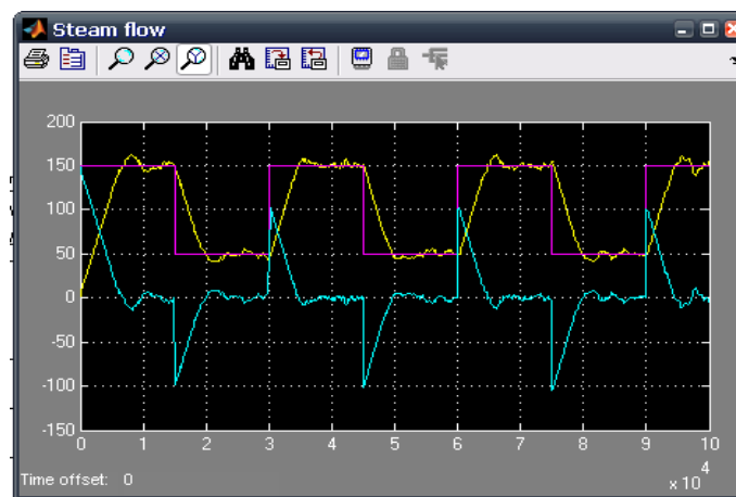
Σχήμα 5.8 Απεικόνιση της ροής ατμού για εισαγωγή θορύβου 3200 στην θερμοκρασία του boiler
