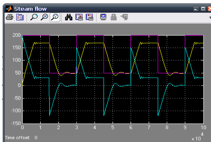
Σχήμα 4.40 Απεικόνιση επιθυμητής και πραγματικής ροής ατμού για καθώς και της μεταβολής του σφάλματος της ροής ατμού για τον ελεγκτή in3out2
